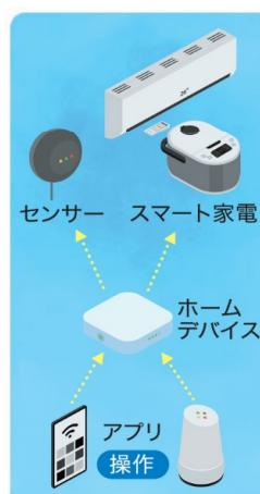
ネットワーク対応の家電や各種センサー、それらをコントロールする管理システム（ホームデバイス）が必要です。一般的な管理システムは、スマホなどからアプリで操作できます。音声アシスタントを使えばハンズフリーでさらに便利に。
